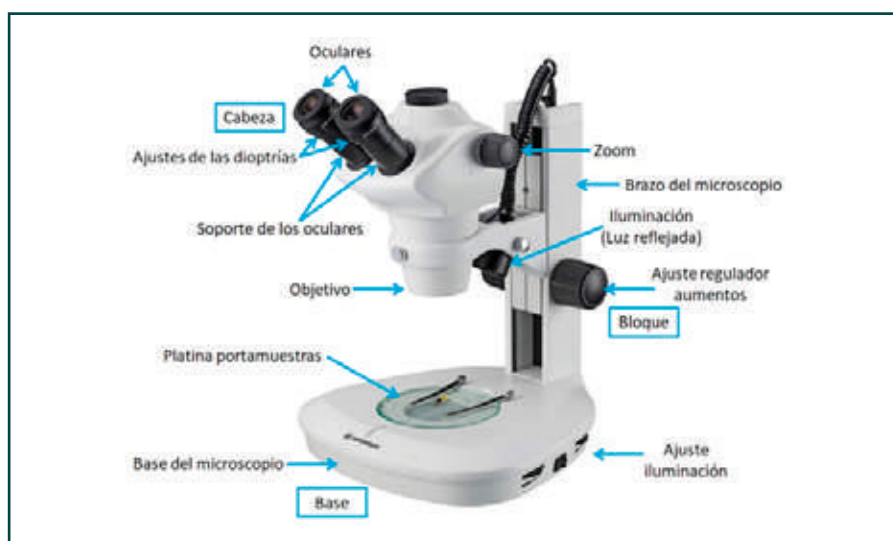
Figura 1 Partes del microscopio de disección
